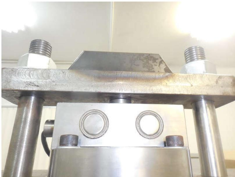
**Figura 29:** Montagem da Barra Retangular Superior.
