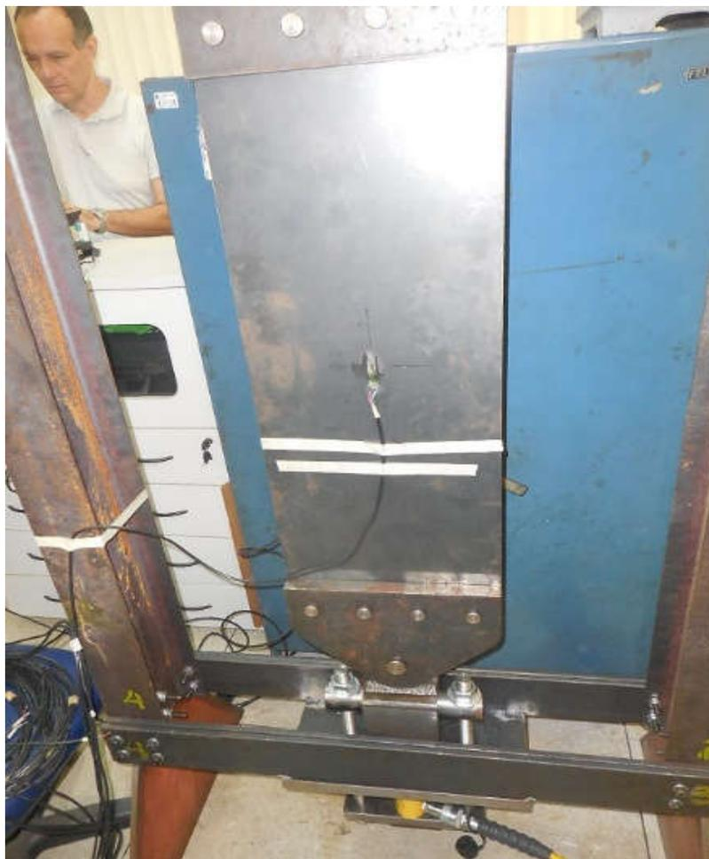
**Figura 47:** Quadro durante teste inicial carregado e travado.
