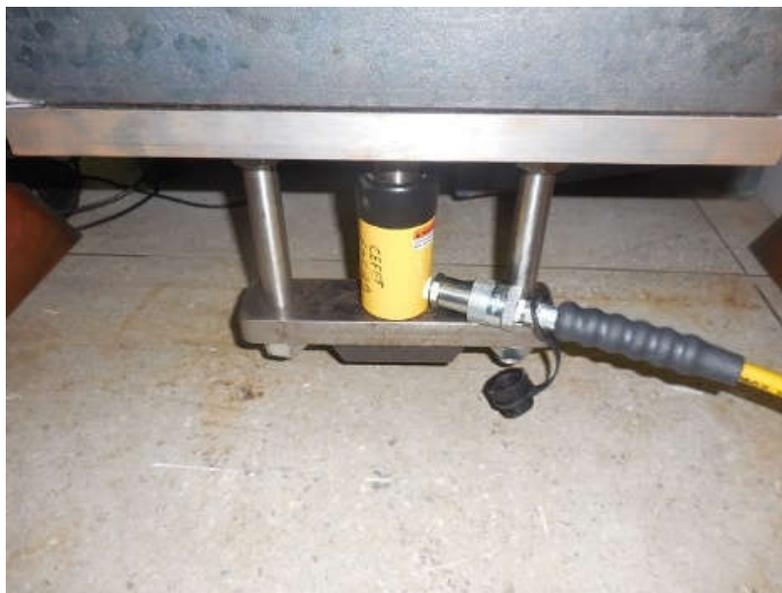
**Figura 46:** Macaco Hidráulico na condição inicial do teste.
