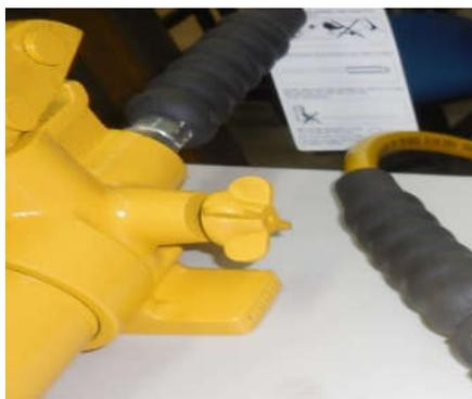
Figura 23: Parafuso de alívio de pressão.
