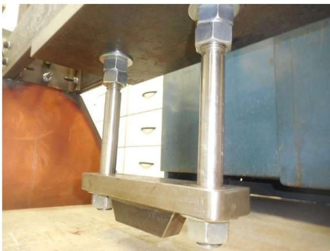
**Figura 38:** Chapa inferior, barra retangular e sistema de travamento.
