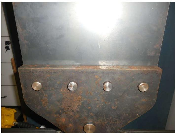
**Figura 35:** Montagem da garra inferior dianteira no Corpo de Prova.
