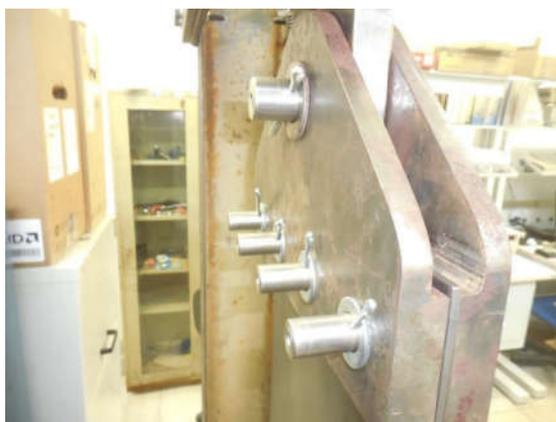
**Figura 34:** Montagem traseira superior do Corpo de Prova.
