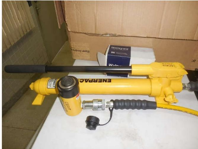
**Figura 24:** Macaco Hidráulico.
