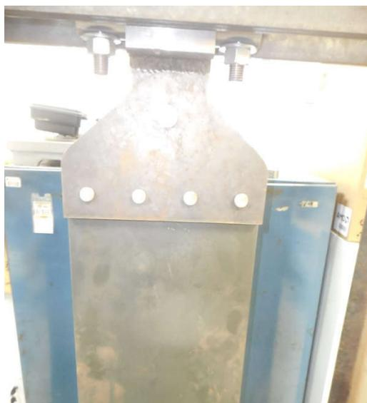
**Figura 33:** Montagem frontal superior do Corpo de Prova.
