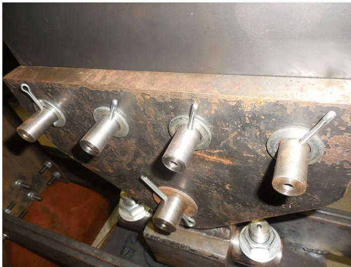
**Figura 36:** Montagem da garra inferior traseira no Corpo de Prova.
